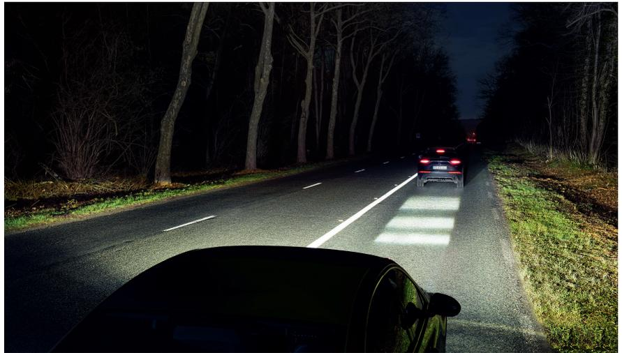
**Bild 3: Beispiel für eine Kollisionswarnungsprojektion auf der Straße** © Valeo
